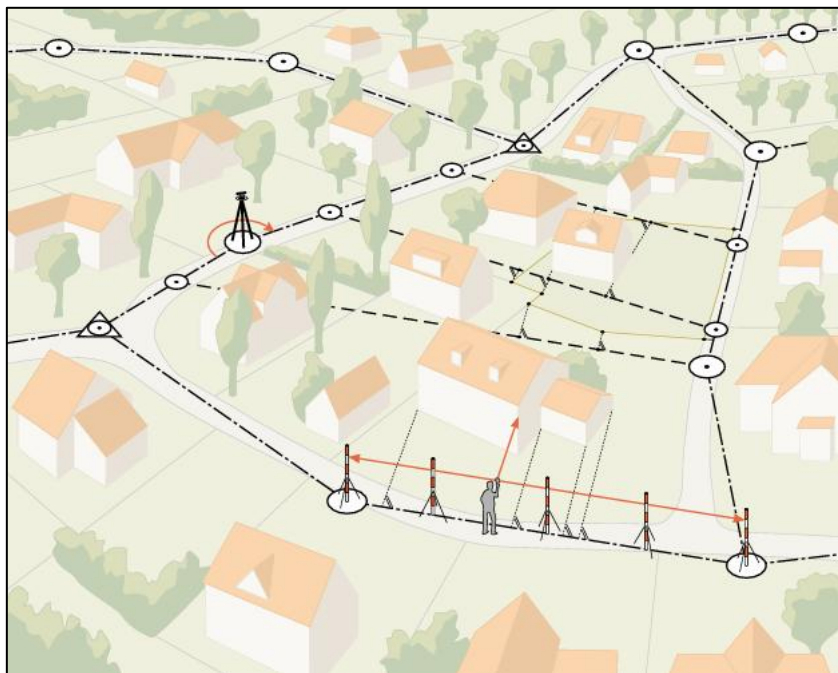
Abbildung 10: Prinzip der Orthogonalaufnahme, hier Polygonieren und Orthogonalverfahren (Seeberger & Holl, 2001, S. 61)
